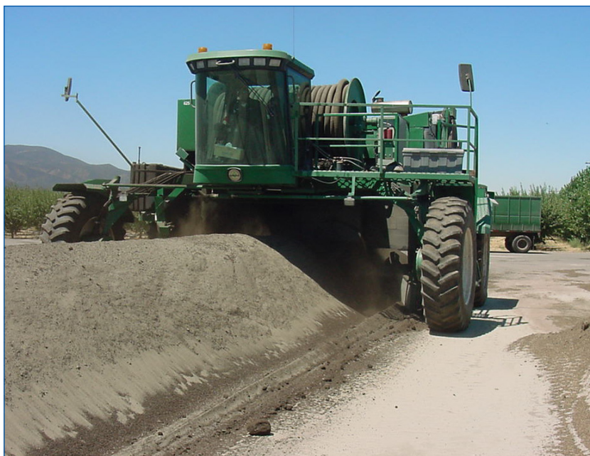
Equipo para la rotación de compost en Groverat Grover Compost en el Valle de San Joaquin, California. El compost debe mantener una temperatura entre 131°F (55°C) y 170°F (77c) por 15 días y ser volteado un mínimo de cinco veces en ese periodo de 15 días para un sistema en hileras. Foto: Rex Dufour, NCAT
